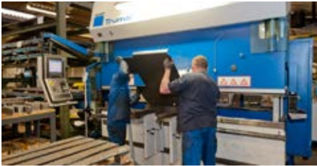
Computerunterstütztes Biegen von Stahlplatten
