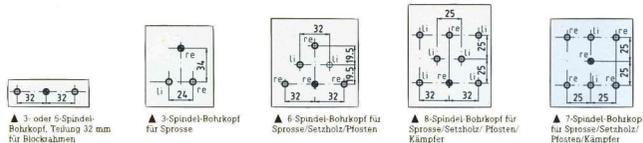
▲ 3 oder 5-Spindel-Bohrkopf, Teilung 12 mm für Blockrahmen    ▲ 3-Spindel-Bohrkopf für Sprosse    ▲ 6-Spindel-Bohrkopf für Sprosse/Setzholz/Pfosten    ▲ 8-Spindel-Bohrkopf für Sprosse/Setzholz/Pfosten/Kämpfer    ▲ 7-Spindel-Bohrkopf für Sprosse/Setzholz/Pfosten/Kämpfer
