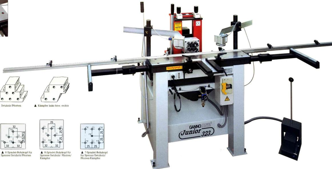
Die neue Rahmendübel- und Langlochbohrmaschine zum Bohren in zwei Ebenen durch pneumatisches Heben und Senken des Bohrmotors bei einer Aufspannung
